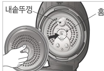
⑥ 뚜껑에 장착시에는 분리형커버 손잡이를 잡고 화살표 방향으로 안쪽의 홈에 맞춘 후 힘주어 눌러주십시오.
